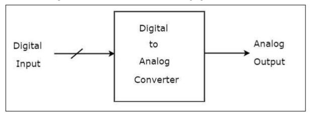
A Digital to Analog Converter (DAC) consists of a number of binary inputs and a single output. In general, the number of binary inputs of a DAC will be a power of two. (Digital to Analog Converter (DAC) में कई बाइनरी इनपुट और एक एकल आउटपुट होता हैं। सामान्य तौर पर, DAC के बाइनरी इनपुट की संख्या power of two में होती है)
