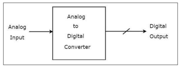
An Analog to Digital Converter (ADC) consists of a single analog input and many binary outputs. In general, the number of binary outputs of ADC will be a power of two.(एनालॉग से डिजिटल कनवर्टर (ADC) में एकल analog input और कई binary outputs होते हैं। ADC के बाइनरी आउटपुट की संख्या 2 के पॉवर में होता है।
